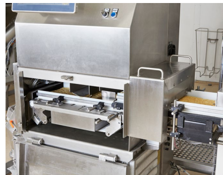
Produktstrom bei geöffneter Anlage. Aufgrund der unterschiedlichen Ebenen innerhalb des Röntgenscanners sind die Transportöffnungen unkritisch und auch im Betrieb strahlungssicher.
