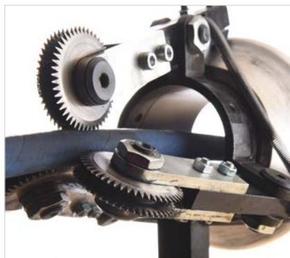
Pricken der Schlauchdecke
