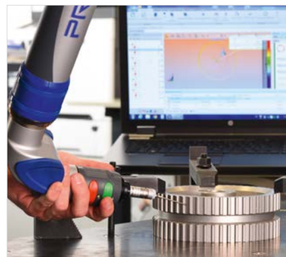
Taktile Messung von Zahnscheiben
