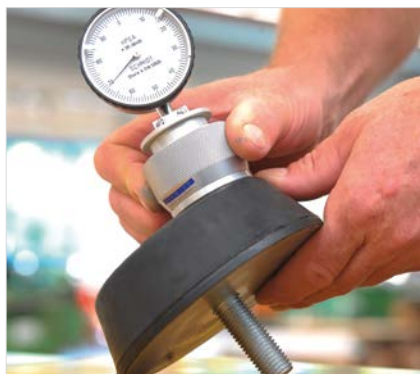
Härteprüfung von Gummi-Metall-Teilen
