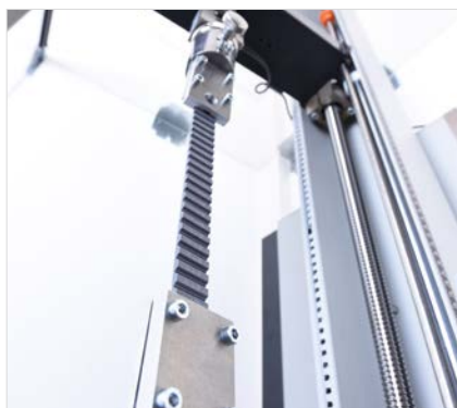
Zugversuch von Zahnriemen
