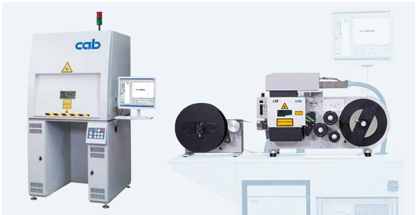
LSG+100E zur Beschriftung von Serienteilen LM+ zur Beschriftung von Etiketten aus laserbeschriftbarer Folie
